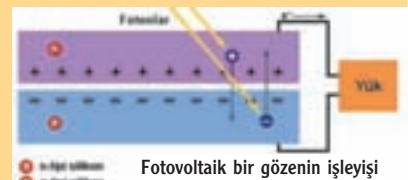
Fotovoltaik bir gözede ki elektrik alanının etkisi
