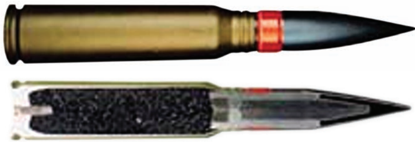
GAU-8, PGU-14/B tipindeki uranyum mermisinin kesiti ve iç yapısı. Merminin, sonundaki ateşleyici bölümüyle birlikte toplam uzunluğu 29 cm ve toplam kütlesi 690 gram. Uranyum çekirdeği merminin ön bölümünde 14,5 cm uzunluğunda olup 270 gram. Merminin hızı saniyede 1 km kadar (saate 3640 km)
