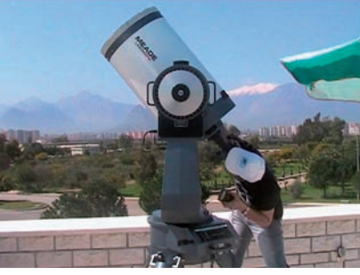
Şekil 6. TUG'un yeni 40 cm ayna çaplı teleskobu ilk ışığı olacak Tam Güneş Tutulması için hazırlanıyor.
