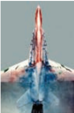
Şekil 1. Mürekkep kullanarak bir uçak modeli etrafında akışın görüntülenmesi ve duman kullanarak bir aracın aerodinamik testleri.
