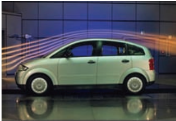
Şekil 1. Mürekkep kullanarak bir uçak modeli etrafında akışın görüntülenmesi ve duman kullanarak bir aracın aerodinamik testleri.
