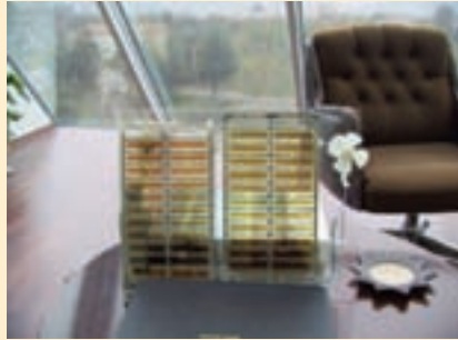
GEE'nde üretilen organik güneş pili 22 paralel 2 seri bağlı OGP aktif alan: 230 cm 2 0.45 Amper x 1.40 Volt 0.63 Watt %3 verim
