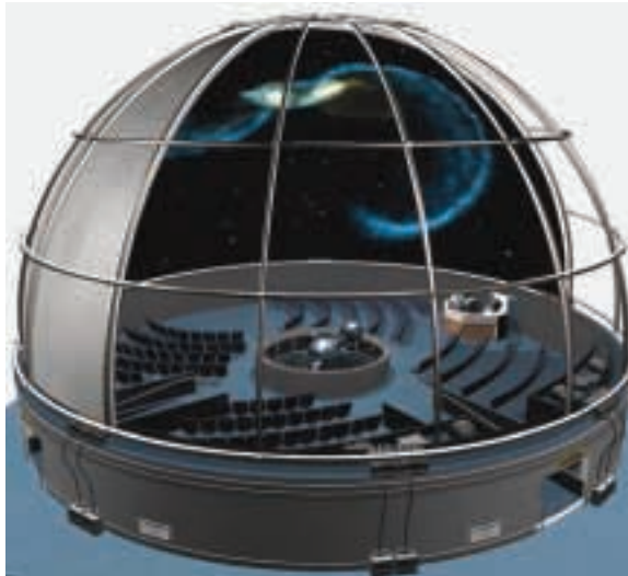
Bir planetariumun kesiti. Planetaryumlarda, koltuklar seyircilerin kubbeyi rahatça görebilecekleri biçimde yerleştiriliyor. Projektör, kubbe yüzeyinin her noktasına eşit uzaklıkta olması için merkeze yerleştiriliyor.
