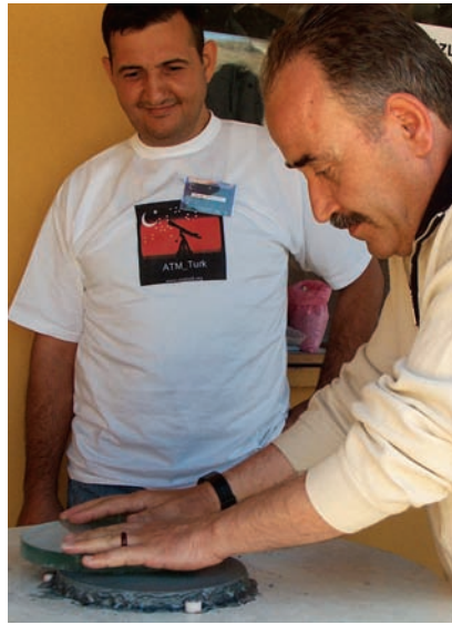
“Teleskop Aynası Yapımı” atölyesinde katılımcılar şenlik süresince sırayla bir camı aşındırarak ayna yapımının en önemli aşamasını tamamlamış oldular.
