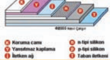
Silikon bir fotovoltaik göze elemanın temel yapısı
